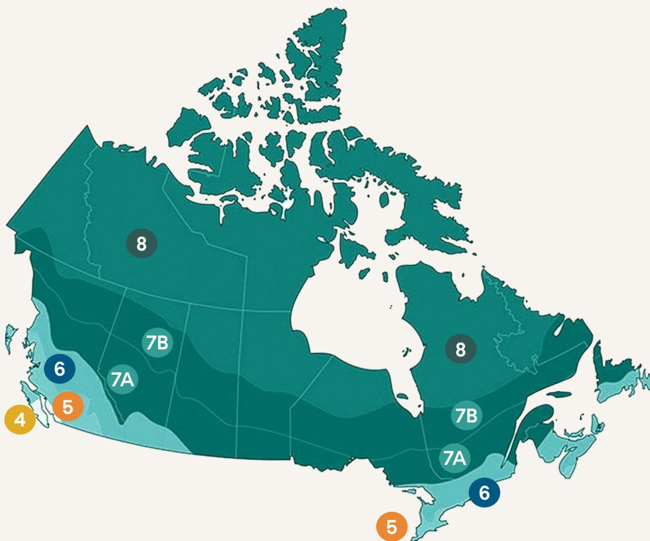
Figure 8 – Zones climatiques utilisées pour déterminer les cibles d'IDET.
